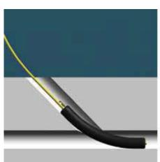
A continuación, se infla la parte superior del obturador para evitar el vertido de líquido.
