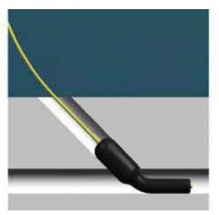
Por último, se infla la parte inferior para cortar el flujo completamente.
